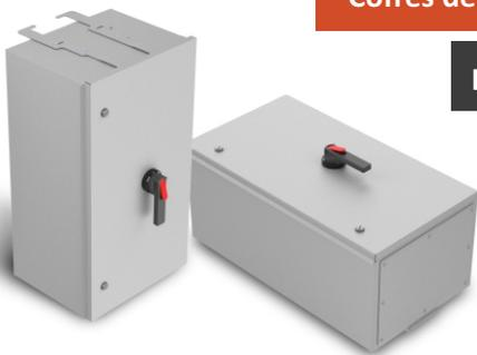
Os cofres de derivação plug in **XBAR SYSTEM** são unidades de derivação de energia em conformidade com a norma internacional IEC 61439-6 e provenientes das linhas de distribuição dos barramentos blindados, projetados para distribuir energia para cargas a jusante do sistema, com dispositivos de proteção, manobra e controle em baixa tensão.
